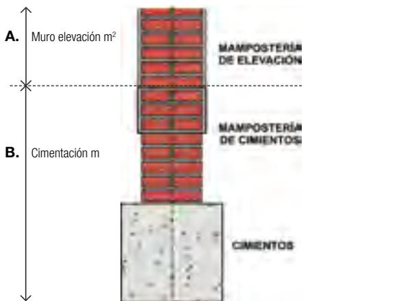
Muro elevación ladrillos comunes 30cm de espesor, con revoques exterior e Interior a la cal comunes. Cimentación que incluye excavación e/suelo normal, zapata s/opciones, mampostería de cimientos y capas aisladoras; s/detalle.
